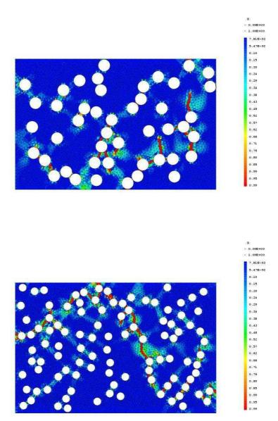
FIG. 2.35: Faciès de rupture obtenus respectivement avec l'éprouvette 1 ( $\phi_1 = 6mm$ ;% surfacique en trous = 20) et l'eprouvette 2 ( $\phi_2 = 4mm$ ; % surfacique en trous = 20) : calcul local avec le modèle d'endommagement de Mazars.
