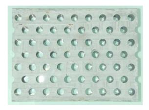
Fig. 2.3: Eprouvette 1 ( $\phi_1 = 5mm$ ; % surfacique en trous = 20).
