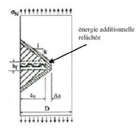
Fig. 1.3: Zones de relâchement des contraintes dans une éprouvette entaillée selon Bazant (Bazant, 2004).
