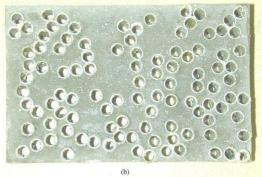
FIG. 2.29: a) Eprouvette 1 ( $\phi_1 = 6mm$ ; % surfacique en trous =20) : configuration aléatoire des trous n°1. b) Eprouvette 2 ( $\phi_2 = 4mm$ ; % surfacique en trous = 20) : configuration aléatoire des trous n°1.
