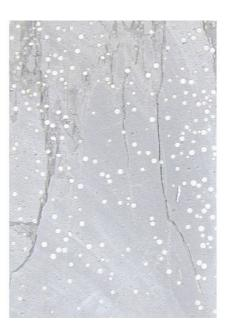
Fig. 4.2: Mécanisme de rupture, par propagation de quelques macroffissures localisées, observé pour les deux bétons de polystyrène renfermant respectivement les billes de 6.3mm et 2.5mm et présentant une faible porosité (coupes longitudinales de deux éprouvettes  $(110 \times 220mm)$ ).
