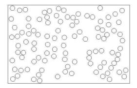
Fig. 2.27: Première configuration aléatoire de trous pour l'éprouvette 2 ( $\phi_2 = 4mm$ ; % surfacique en trous =20).
