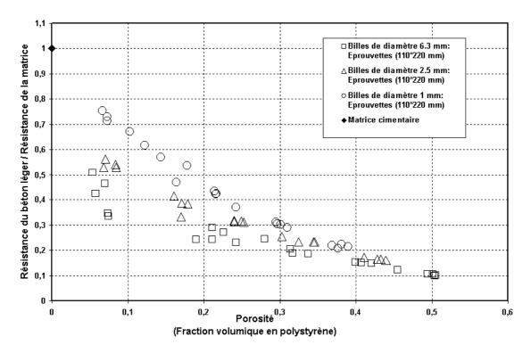
Fig. 3.9: Résistances en compression normalisées obtenues avec les trois types de béton de polystyrène : essais sur des éprouvettes de taille  $(110 \times 220mm)$ .
