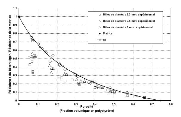
Fig. 4.7: Ajustement de la fonction hyperbolique approchant la borne supérieure  $\mathbf{g_0}(p)$  grâce aux résistances normalisées obtenues expérimentalement avec les trois types de béton de polystyrène.
