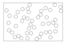
Fig. 2.26: Première configuration aléatoire des trous pour l'éprouvette 1 ( $\phi_1 = 6mm$ ; % surfacique en trous =20).
