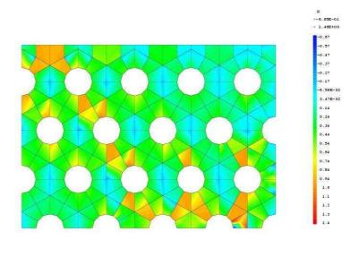
Fig. 2.14: Faciès de rupture obtenu avec l'éprouvette 1 ( $\phi_1 = 5mm$ ) : calcul local avec un maillage grossier (12 éléments par trou).
