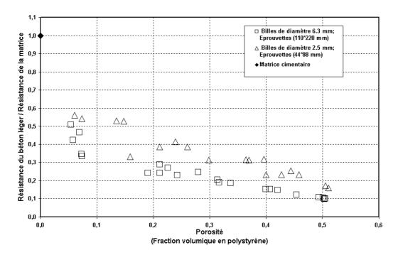
FIG. 3.7: Résistances en compression normalisées obtenues avec les billes de diamètres  $\phi_2 = 2.5mm$  et  $\phi_3 = 6.3mm$ : résultats pour un rapport d'homothétie constant ( $\frac{D}{\phi} = 17.6$ ).
