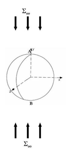
Fig. 4.8: Schéma d'un milieu 3D infini renfermant une cavité sphérique et chargé en compression simple : mode de rupture fragile par extension.
