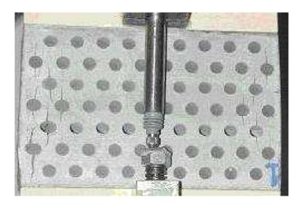
Fig. 2.7: Faciès de rupture au début de l'essai de compression : initiation des fissures sur les bords de l'éprouvette 1 ( $\phi_1 = 5mm$ ; % surfacique en trous = 20).
