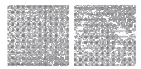
Fig. 5.6: Faciès de rupture au début de l'essai de compression et au pic d'effort obtenus avec un réseau de taille  $(50 \times 50)$  renfermant des trous de taille  $D = L_c = 1$ .
