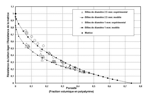
Fig. 4.11: Comparaison entre les résistances normalisées expérimentales et celles données par le modèle pour les bétons de polystyrène renfermant les billes de diamètres 1mm et 2.5mm.
