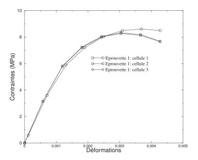
Fig. 2.21: Courbes numériques de compression des trois cellules représentant l'éprouvette 1  $(\phi_1 = 5mm, \% \text{ surfacique en trous} = 20)$ : calcul non local avec le modèle d'endommagement de Mazars.
