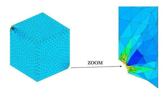
Fig. 4.9: Distribution des déformations élastiques équivalentes d'extension dans un huitième de la cellule de base d'un réseau périodique (CC) ayant une porosité proche de zero ( $p = 10^{-04}$ ) : maximum atteint autour des trous.
