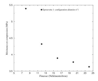
Fig. 2.39: Résistances en compression obtenues avec la première configuration aléatoire des trous correspondant à l'éprouvette 1 ( $\phi_1 = 6mm$ ; % surfacique en trous = 20), pour différentes finesses du maillage : calcul local.
