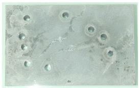
FIG. 2.32: a) Eprouvette 1 ( $\phi_1 = 6mm$ ; % surfacique en trous = 1.8) : configuration aléatoire des trous n°1. b) Eprouvette 2 ( $\phi_2 = 4mm$ ; % surfacique en trous = 1.8) : configuration aléatoire des trous n°1.
