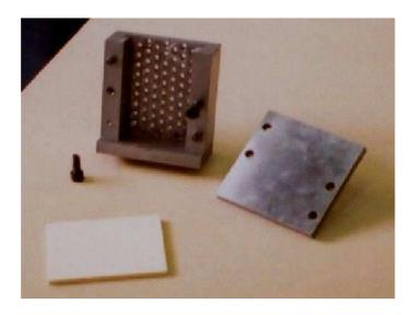
Fig. 2.2: Moule conçu pour le coulage des éprouvettes d'essai.
