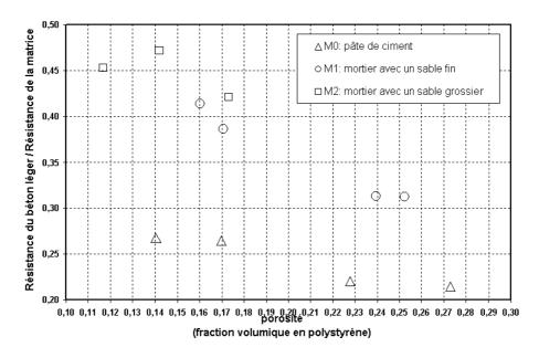
Fig. 3.11: Résistances en compression normalisées obtenues avec les billes de diamètre  $\phi_2 = 2.5mm$  et les trois types de matrice cimentaire.
