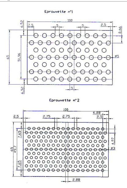
Fig. 2.1: Plans de deux éprouvettes d'essai.
