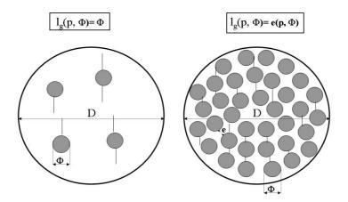
Fig. 4.5: La longueur géométrique  $l_g(p,\phi)$  dans les cas de très faibles et de très fortes porosités.
