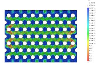
Fig. 2.18: Faciès de rupture au début de l'essai de compression obtenu avec un calcul non local : initiation de l'endommagement sur les bords de l'éprouvette 1 ( $\phi_1 = 5mm$ ).
