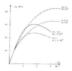
Fig. 2.11: Modèle d'endommagement de Mazars en compression (Mazars, 1984).
