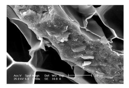
Fig. 3.2: Photo au MEB montrant la très bonne qualité de l'interface entre les billes de polystyrène et la matrice cimentaire (photo Berthelot : PCM - LCPC).
