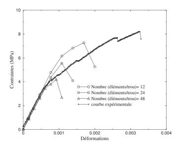
Fig. 2.15: comparaison entre la courbe de compression expérimentale de l'éprouvette 1 ( $\phi_1 = 5mm$ ) et les courbes numériques obtenues avec un calcul local pour trois finesses différentes du maillage.
