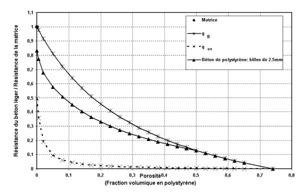
FIG. 4.10: Résistance normalisée du béton de polystyrène renfermant les billes de diamètre 2.5 mm en fonction de la porosité p, d'après le modèle proposé.
