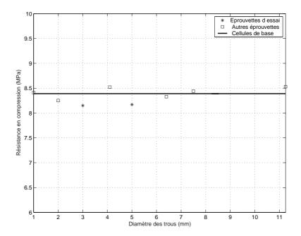
FIG. 2.23: Résistances en compression numériques des éprouvettes renfermant des trous de diamètres compris entre 1 et 11.25mm : calcul non local.
