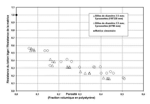
Fig. 3.5: Résistances en compression normalisées des bétons légers renfermant les billes de diamètre  $\phi_2 = 2.5mm$ , obtenues avec les deux types d'éprouvettes d'essai.
