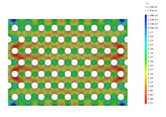
Fig. 2.19: Faciès de rupture au pic d'effort obtenu avec un calcul non local : propagation de l'endommagement vers le centre de l'éprouvette 1 ( $\phi_1 = 5mm$ ).
