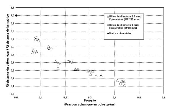
FIG. 3.6: Résistances en compression normalisées obtenues avec les billes de diamètres  $\phi_1 = 1mm$  et  $\phi_2 = 2.5mm$ : résultats pour un rapport d'homothétie constant  $(\frac{D}{\phi} = 44)$ .
