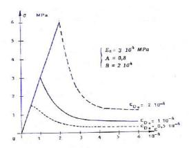
Fig. 2.10: Modèle d'endommagement de Mazars en traction (Mazars, 1984).
