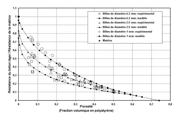
Fig. 4.12: Comparaison entre les résistances normalisées expérimentales et celles données par le modèle, pour les trois types de béton de polystyrène.
