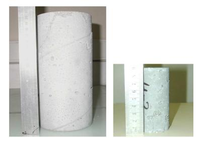
FIG. 3.3: Eprouvettes homothétiques de béton de polystyrène de tailles :  $(110 \times 220mm)$  et  $(44 \times 88mm)$  : rapport d'homothétie égal à 2.5.
