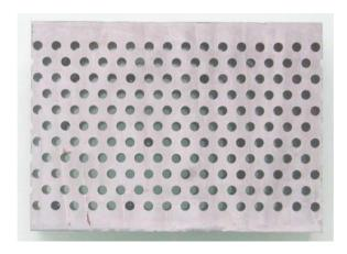
Fig. 2.4: Eprouvette 2 ( $\phi_2 = 3mm$ ; % surfacique en trous = 20).
