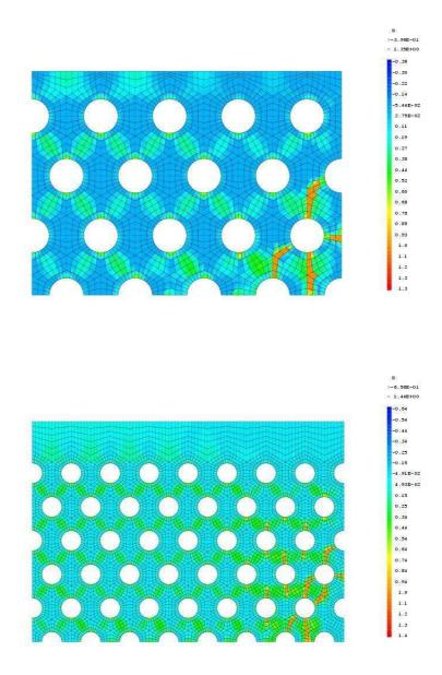
Fig. 2.13: Faciès de rupture obtenus respectivement avec l'éprouvette 1 ( $\phi_1 = 5mm$ ) et l'eprouvette 2 ( $\phi_2 = 3mm$ ) : calcul local avec un maillage suffisamment fin (36 éléments par trou).
