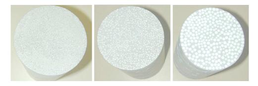
Fig. 3.1: Les trois tailles homothétiques des billes de polystyrène expansé considérées dans cette étude :  $\phi_1 = 1mm$ ,  $\phi_2 = 2.5mm$  et  $\phi_3 = 6.3mm$  : rapport d'homothetie égal à 2.5.
