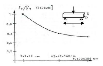
Fig. 1.2: Effet d'échelle de structure d'après (L'Hermite, 1973).
