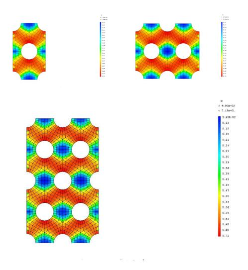
Fig. 2.22: Distributions de l'endommagement au pic d'effort dans les trois cellules de tailles croissantes représentant l'éprouvette 1 ( $\phi_1 = 5mm$ , % surfacique en trous = 20) : calcul non local avec le modèle d'endommagement de Mazars.
