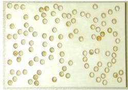
Fig. 2.28: Deux plaques, constituant deux fonds du moule, percées respectivement selon la première configuration aléatoire des trous pour l'éprouvette 1 ( $\phi_1 = 6mm$ ) et pour l'éprouvette 2 ( $\phi_2 = 4mm$ ).
