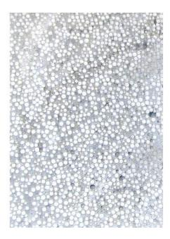
Fig. 4.3: Mécanisme de rupture, par microfissuration diffuse, observé pour les deux bétons de polystyrène renfermant respectivement les billes de 6.3mm et 2.5mm et présentant une forte porosité (coupes longitudinales de deux éprouvettes  $(110 \times 220mm)$ ).
