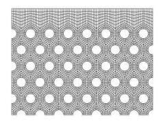
Fig. 2.9: Maillage avec Castem2000 des quarts de l'éprouvette 1 ( $\phi_1 = 5mm$ ) et l'éprouvette 2 ( $\phi_2 = 3mm$ ).
