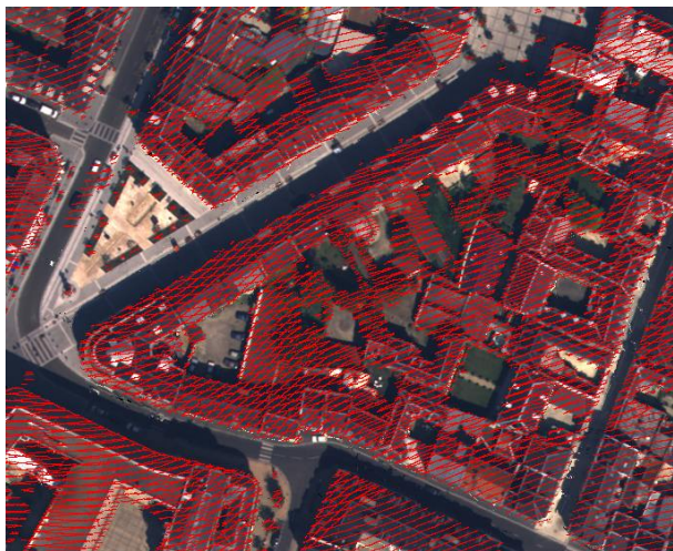
(b) On remarque que les cours intérieures appartiennent bien à la classe sol
