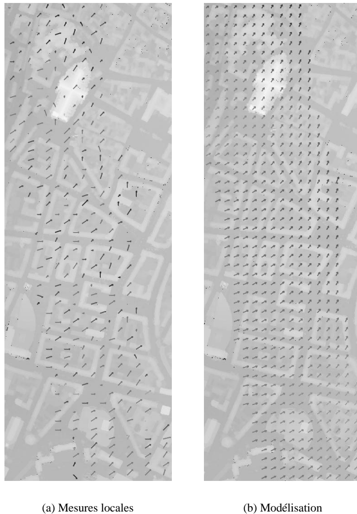
FIG. 5.13 – Champ de déformation mesuré et modélisé pour le recalage d’une bande laser sur un MNE photogrammétrique.
