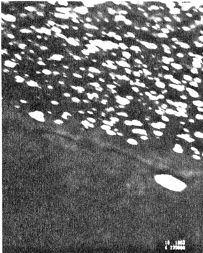
2b: MET Champ sombre sur un joint de grain debout, illustrant à la fois, la relation entre l'appauvrissement en précipités \gamma' , \gamma'' et la présence de nodules intergranulaires ainsi que l'ancrage des joints par ces mêmes nodules.
