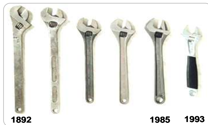
Figure N°3 : Evolution des clefs à mollette (Sandvik, 95)
