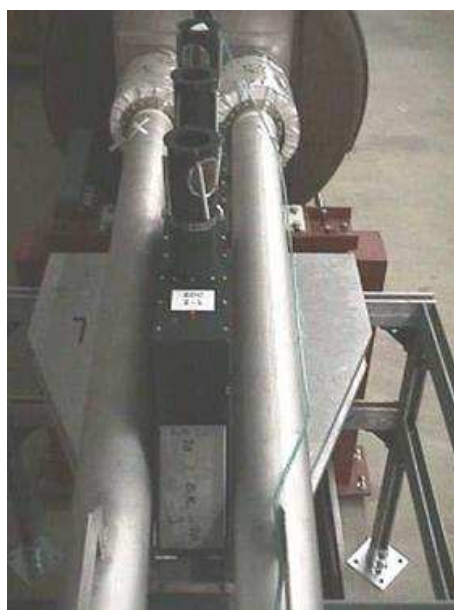
FIG. II.6 – Photographie d'un ZDC installé entre les deux tubes de faisceaux.
