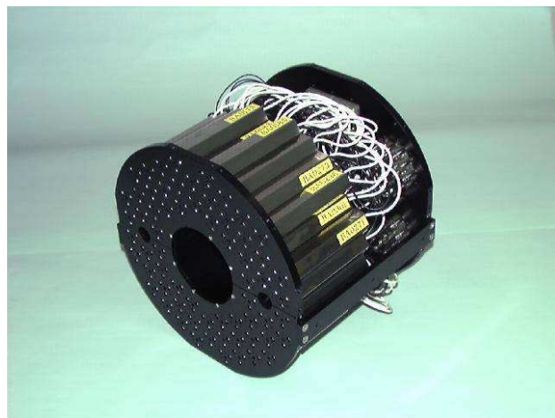
FIG. II.4 – Photographie d'un détecteur BBC. Le rayon de ce cylindre est de 29 cm et sa longueur est de 25 cm.
