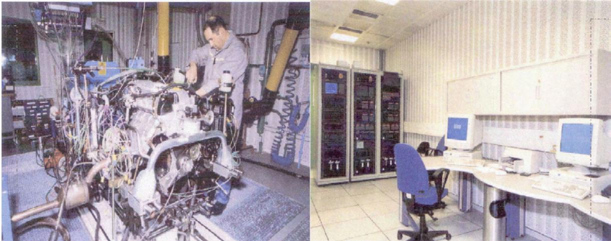
**Figure 11** : *gauche* : banc haute dynamique (BHD) pour la mise au point moteur. *droite* : station de contrôle et baie d'analyse des gaz polluants.
