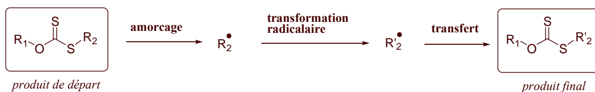
Figure 1- 17 : Bilan de la réaction radicalaire par transfert de xanthate
