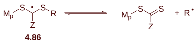
Figure 4- 30 : Fragmentation de la liaison S-R au cours de la polymérisation RAFT
