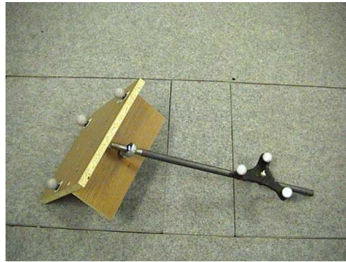
Figure 16 : Dispositif expérimental utilisé pour la validation de la détermination du centre de la tête fémorale
