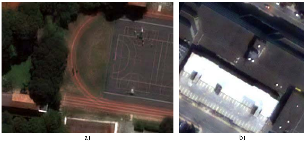
Figure 6.21 : a) Composition colorée qui reprend l'exemple CNES au-dessus de Toulouse, issue de la fusion par ATWT-EnhancedRWM , b) extrait Quickbird au-dessus de Fredericton, même méthode de fusion.
