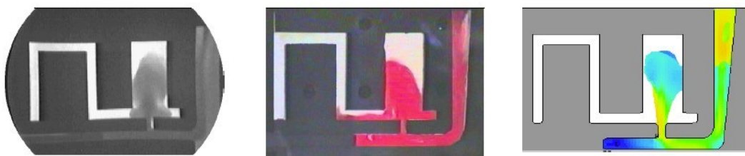
Figure 7. Comparaison de modèles d'observation de la coulée (de gauche à droite : rayons X, analogie hydraulique, simulation numérique) [Schumann et al. 2000b]
