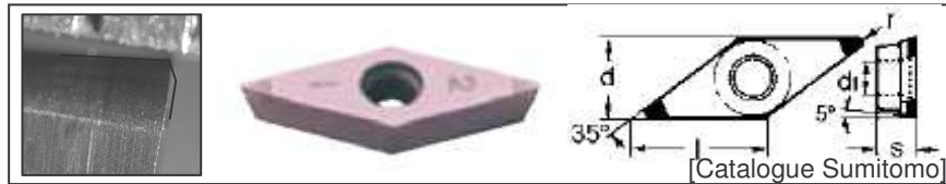
Figure III-7. Représentation schématique de la plaquette utilisée en chariotage.
