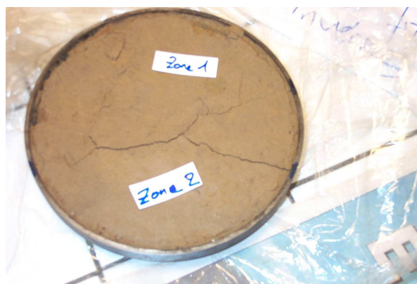
Figure 3-37 : Fissures observées après l'essai d'endommagement d'un échantillon de sol 3,50m
