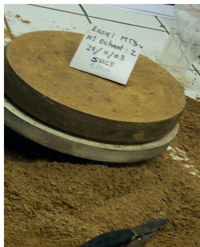
Figure 2-11: Carottage d'un échantillon pour un essais au MTS
