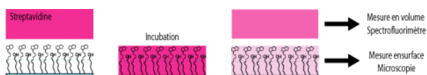
FIG. 2.4 – Après un certain temps laissé pour la fixation de la streptavidine sur les lamelles, on prélève le liquide qui contient la fraction de protéines encore en suspension, que l'on dosera en volume à l'aide d'un spectrofluorimètre. Après rinçage, on mesure l'intensité de fluorescence de la lamelle en microscopie. est
