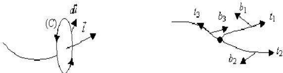
FIG. 1.9 – circulation de  $\text{grad } \vec{u}$  et loi des noeuds
