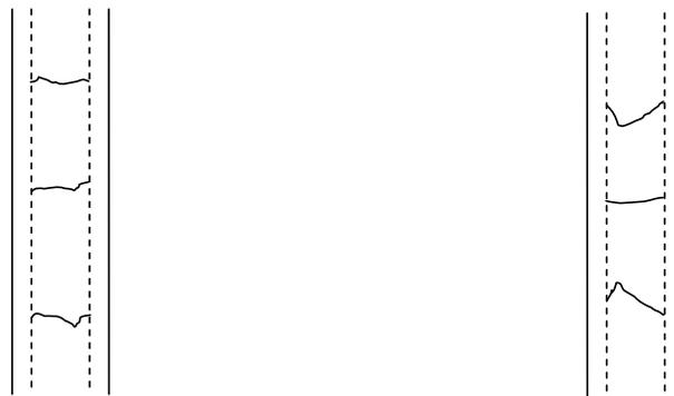
Figure II-16 : Schéma de fissuration
