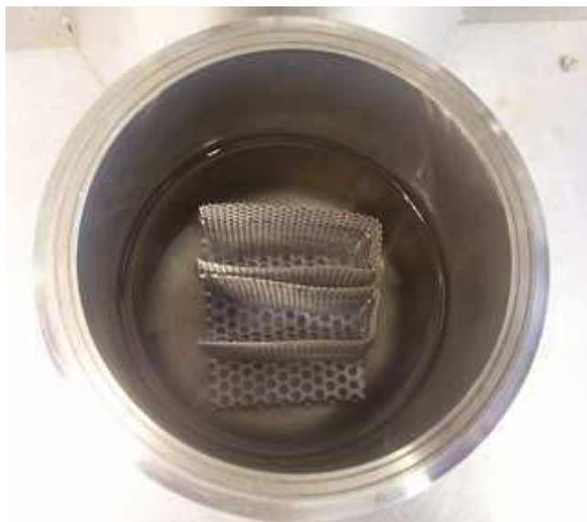
Figure III-5 : Positionnement des gels dans l'autoclave
