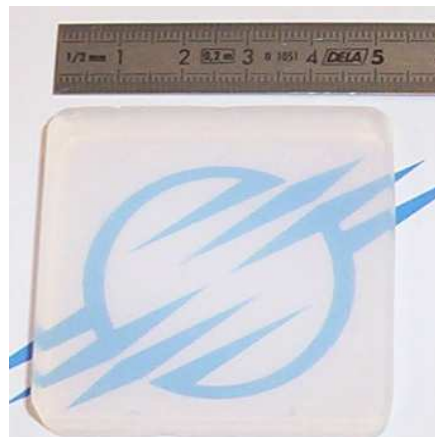
Figure III-17 : Photo d'aérogel issu d'une extraction de référence « raccourcie » (~ 2 heures de lavage dynamique)
