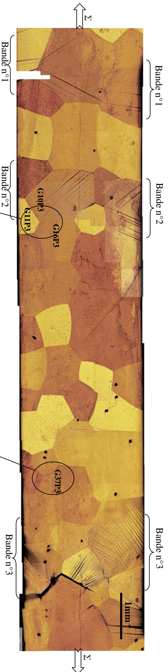
Figure III-39 : Evolution microstructurale de l'ensemble des grains de l'éprouvette P3 au cours du deuxième cycle pour le point d'analyse ( \epsilon=1,54\% , Z=150MPa ). Debut de transformation du grain analysé G16P3, la première plaquette de martensite est apparue sur le joint triple avec les grains G10P3 et G11P3
