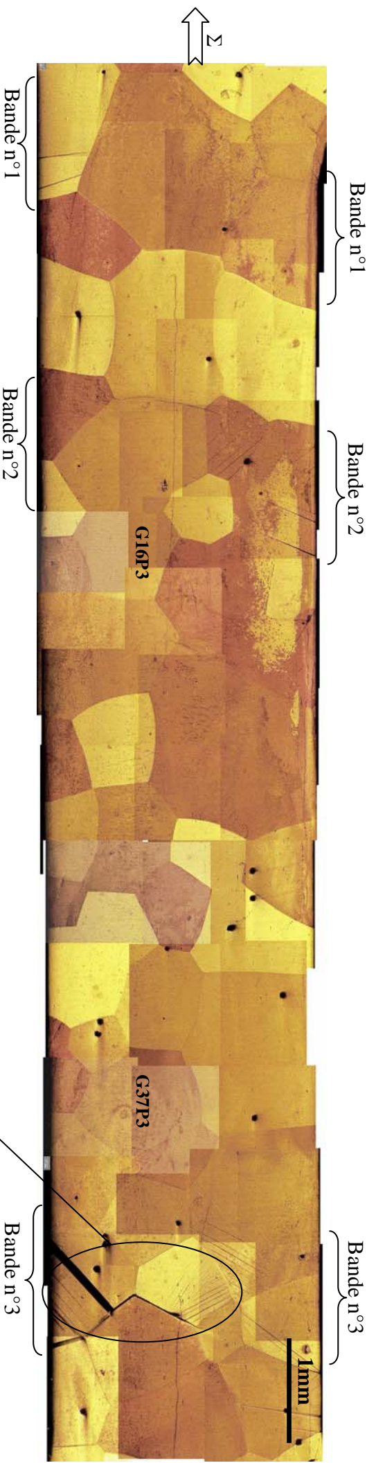
Figure III-37 : Evolution microstructurale de l'ensemble des grains de l'éprouvette P3 au cours du deuxième chargement pour le point d'analyse \epsilon=1,03\% , \Sigma=130MPa . Localisation de la transformation au voisinage du joint de grains où la décohésion intergranulaire s'est produite
