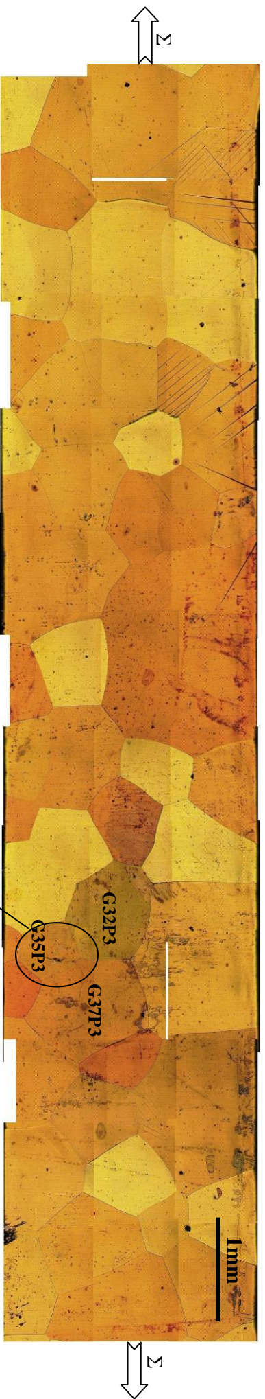
Figure III-25 : Evolution microstructurale de l'ensemble des grains de l'éprouvette P3 pour le point d'analyse \epsilon=1,8\% et \Sigma=190MPa . Ce point correspond au début de transformation dans le grain analysé G37P3, cette dernière s'amorce particulièrement à partir de joint triple avec les grains G35P3 et G32P3
