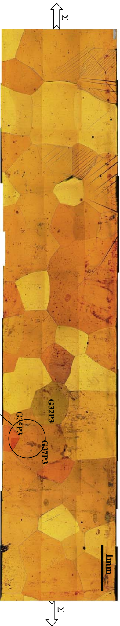
Figure III-32 : Evolution microstructurale de l'ensemble des grains de l'éprouvette P3 pour le point d'analyse \epsilon=2,04\% et \Sigma=200MPa . Ce point correspond à l'apparition de la deuxième plaque de martensite dans le grain analysé G37P3, qui se forme à partir de joint triple avec les grains G38P3 et G36P3
