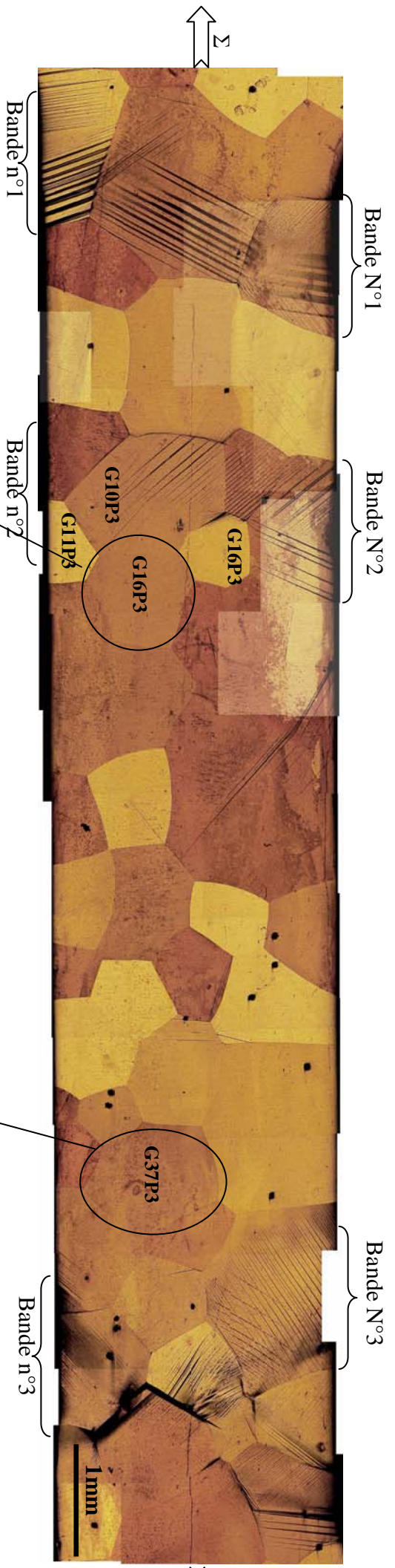
Figure III-40 : Evolution microstructurale de l'ensemble des grains de l'éprouvette P3 au cours du deuxième cycle pour le dernier point d'analyse \epsilon=1,95\% ,
