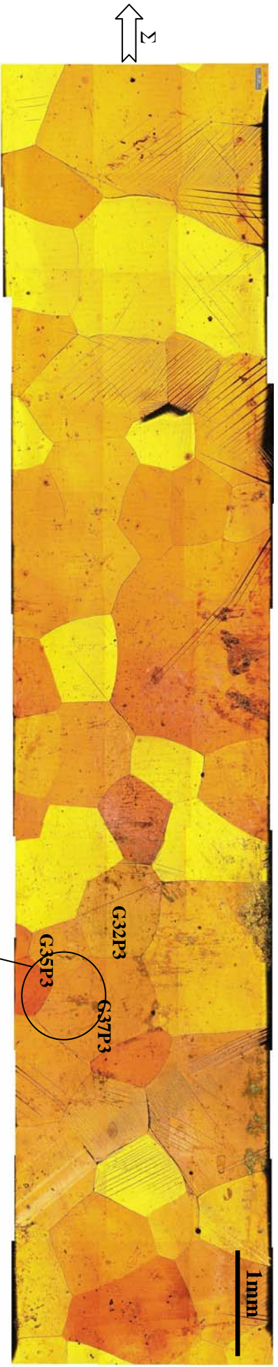
Figure III-33 : Evolution microstructurale de l'ensemble des grains de l'éprouvette P3 pour le point d'analyse \epsilon=2,43\% et \Sigma=220MPa
