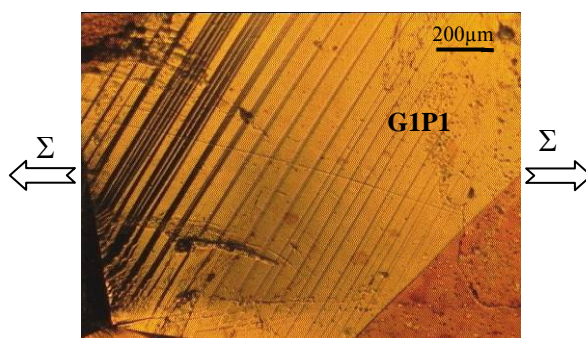
Figure III-14 : Progression de la transformation martensitique dans le grain G1P1 par épaissement des plaquettes et formation de domaines continus de martensite ( \varepsilon=1,7\% )
