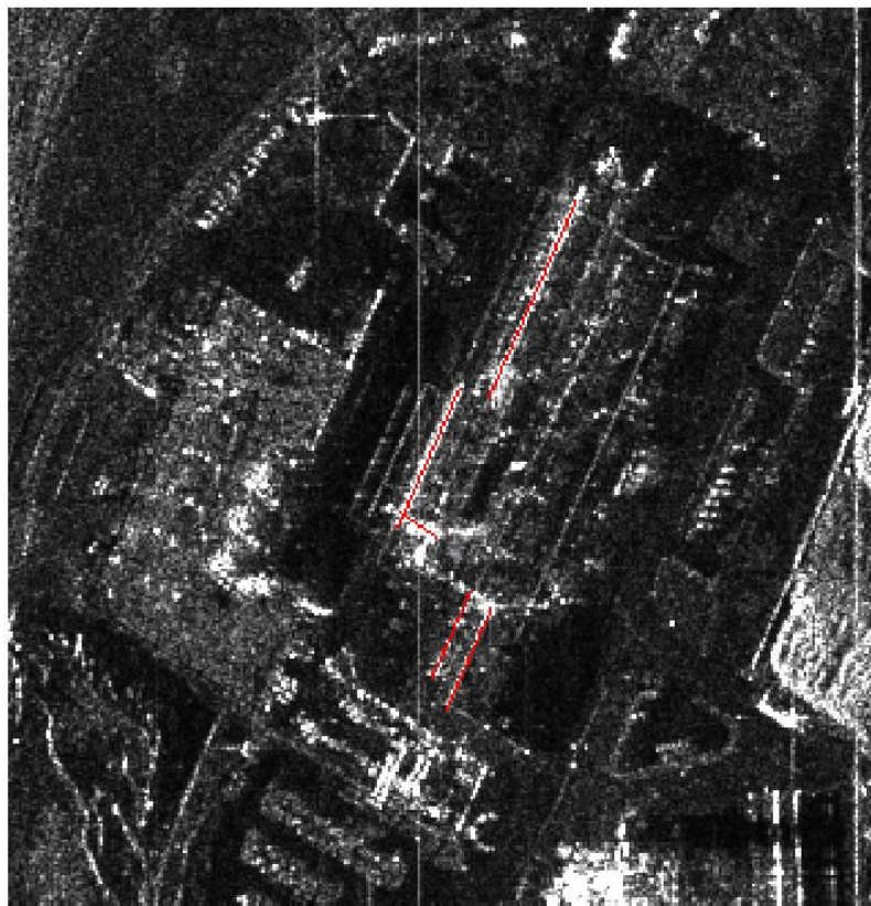
Figure 105 – extraction des échos : a) image d'amplitude avec seuillage global de l'image d'amplitude, b) sélection des échos du bâtiment et c), résultats de la croissance de rectangle pour des paramètres \beta=1^\circ , \varepsilon=1 pixel, variation de i_0 et j_0 de \pm 3 pixels (taille mini = 5m)
