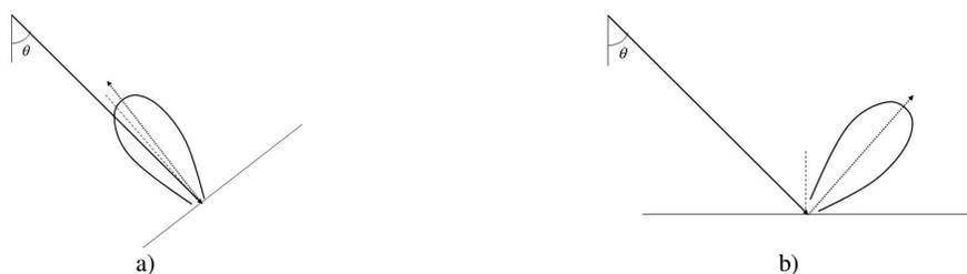
Figure 25 – Représentation de la direction principale (flèche) et du lobe d'antenne de l'onde RADAR après avoir subi une réflexion simple sur une surface lisse a) orientée vers le capteur et b) horizontale
