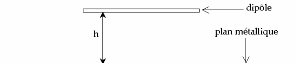
Figure 5 : Dipôle placé parallèlement au-dessus du plan métallique
