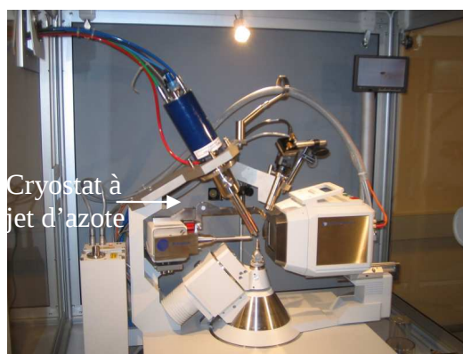
Figure 2.15 : Diffractomètre 4 cercles Oxford Diffraction avec détecteur CCD 2D et muni dans cette configuration du cryostat à jet d'azote.
