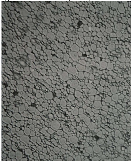
Figure 61: Micrographie optique d'un échantillon de YIG substitué au cuivre ( x = 0,28 ), fritté à 1070°C sous O_2 grandissement : x 500
