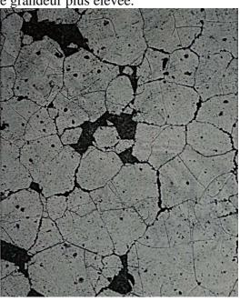
Figure 62: Micrographie optique d'un échantillon de YIG substitué au cuivre (x = 0,28), fritté à 1080°C sous O<sub>2</sub> grandissement : x 25
