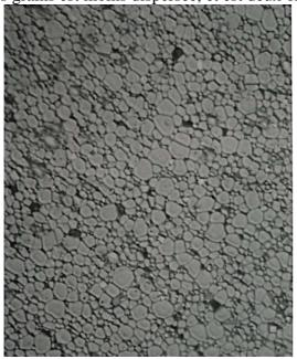
Figure 61: Micrographie optique d'un échantillon de YIG substitué au cuivre (x = 0,28), fritté à  $1070^{\circ}$ C sous  $O_2$  grandissement : x 500
