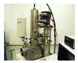
Figure 118: MEB Topcon ABT-150F équipé d'une chaine de mesure EDS Kevex/Noran, utilisé pour les analyses élémentaires EDS
