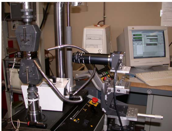
Figure 4 : Photo du montage utilisé pour l'essai avec « Suivi de marqueurs ».
