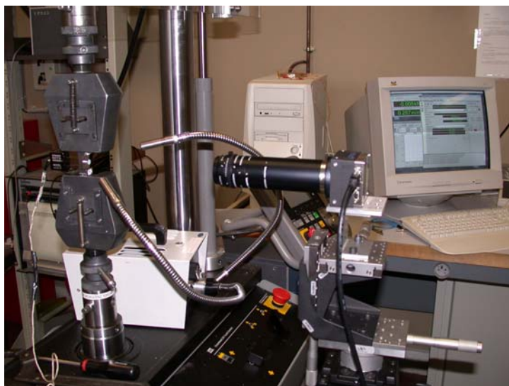
Figure 4 : Photo du montage utilisé pour l'essai avec « Suivi de marqueurs ».
