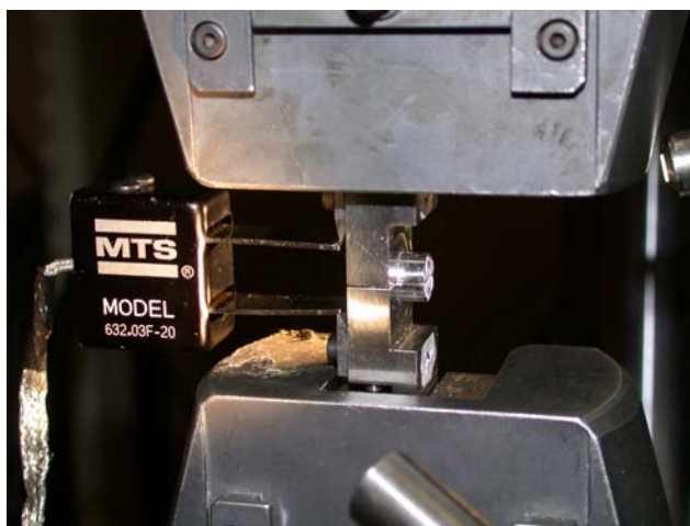
Figure 5 : A gauche : photo d'une éprouvette avec les 3 couples de marqueurs (le couple Nord-Sud, en bleu, utilisé pour accéder à la déformation conventionnelle, le couple Est, en rouge, et le couple Ouest, en vert). A droite : photo de l'extensomètre utilisé et positionné sur le montage (dépourvu d'anneau sur cette illustration).
