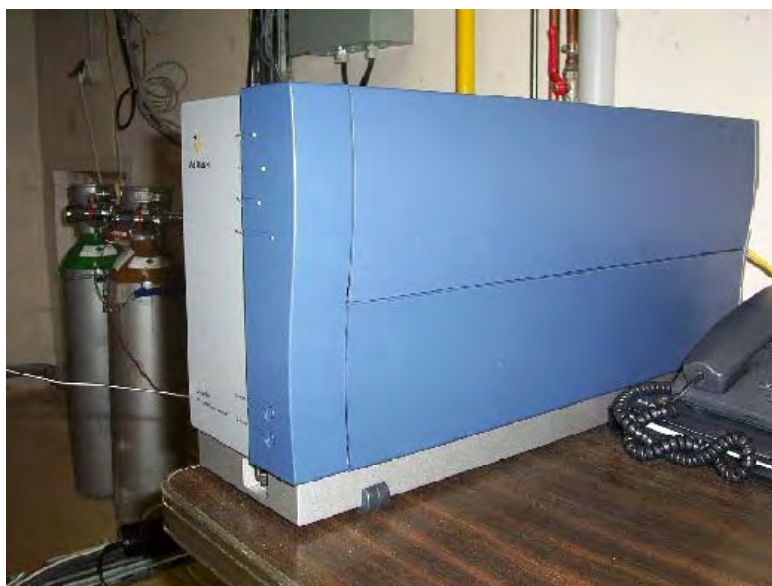
figure III. 1 : Micro-GC (g.) et condenseur à effet Peltier (dr.)
