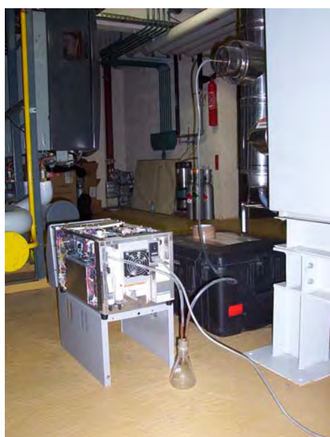
figure III. 3 : analyseur de fumées
