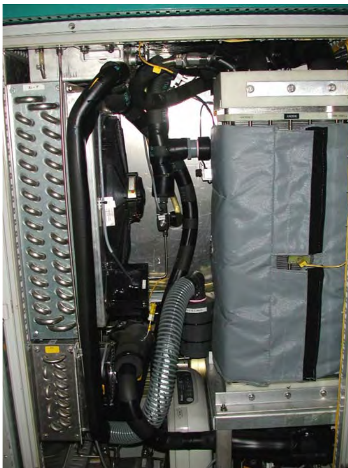
figure II. 6 : compartiment du stack (g.) et stack sans son calorifuge (dr.)
