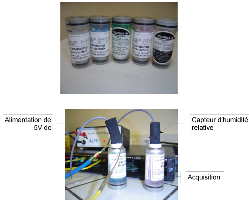
figure 3. 28 : Vue des solutions salines et positionnement des capteurs
