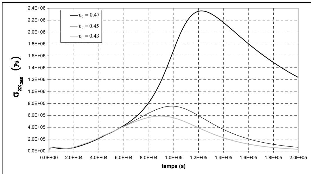
**Figure 4.14** Influence de la variation des valeurs initiales du coefficient de Poisson ( $\nu$ ) sur la contrainte maximale selon la direction x ( $\sigma_{xx_{max}}$ )
