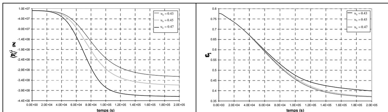
**Figure 4.18** Évolution de la pression intrinsèque du liquide  $\langle P_1 \rangle^1$  (graphique droite) et de la fraction volumique du liquide  $\epsilon_1$  (graphique gauche) dans le point P2 du milieu.
