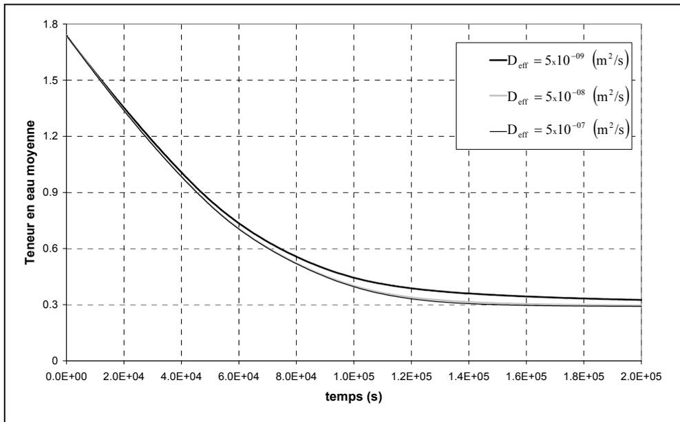
**Figure 4.23** Influence de la variation de la perméabilité ( $k$ ) dans la cinétique de séchage.
