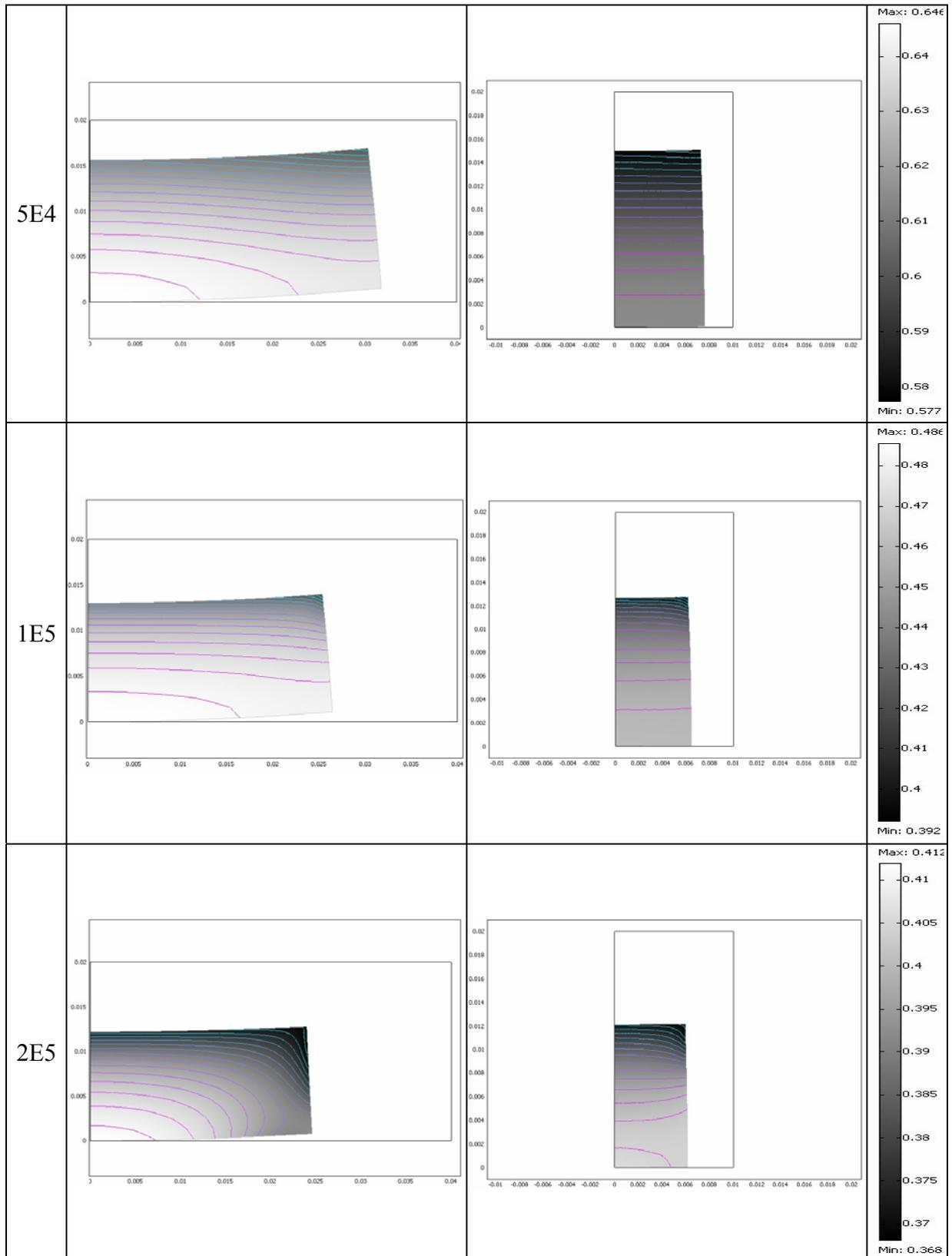
**Figure 4.30** Influence de la variation du rapport de forme ( $L/e$ ) sur les champs de fraction volumique du liquide  $\varepsilon_1$  et la déformation macroscopique du milieu (les axes vertical et horizontal représentent le coordonnées  $x$  et  $y$  dans le système de référence fixe ou initial).
