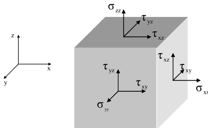
**Figure 2.4** Représentation de contraintes dans un cube différentiel.
