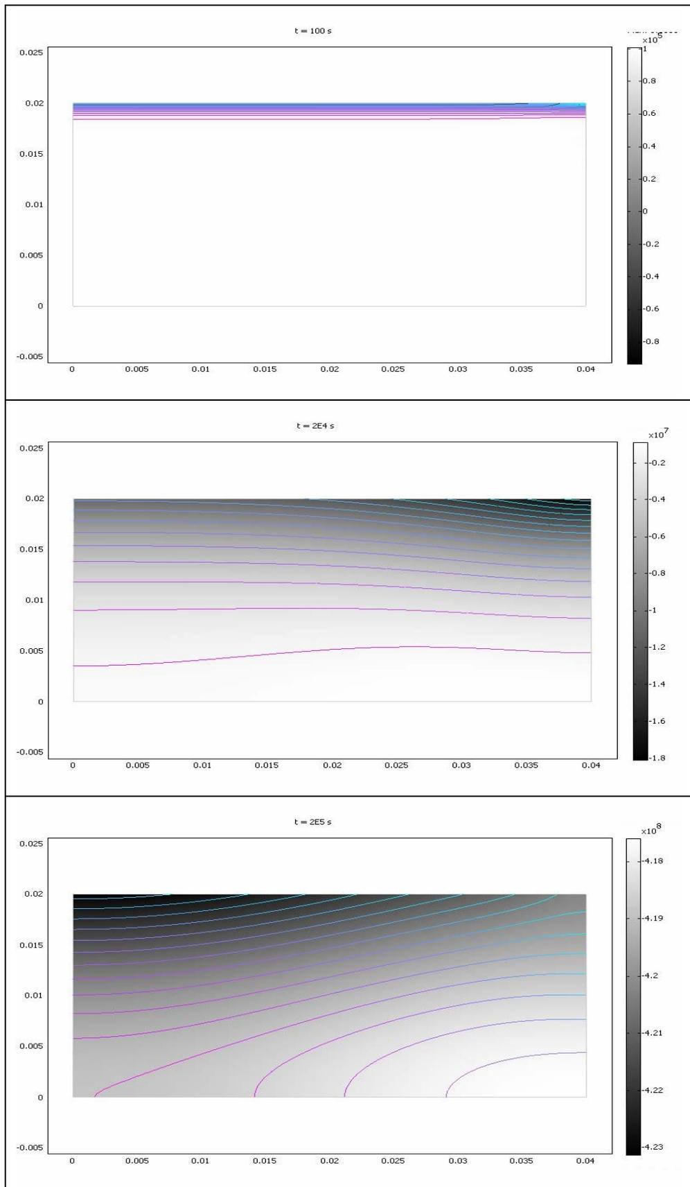
**Figure 4.10** Champs de pression du liquide  $\langle P_1 \rangle^l$  (Pa) projetés sur la géométrie initiale du milieu pour différents instants du séchage (les axes vertical et horizontal représentent les coordonnées x et y).
