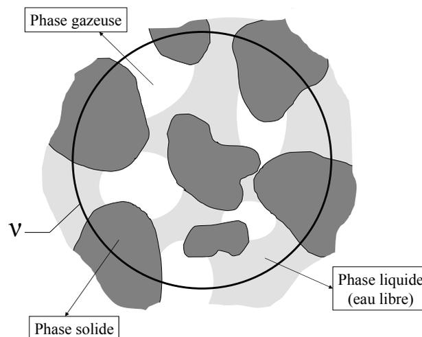
**Figure 2.1** Phase liquide, gazeuse et solide dans le V.E.R. ( $v$ ).
