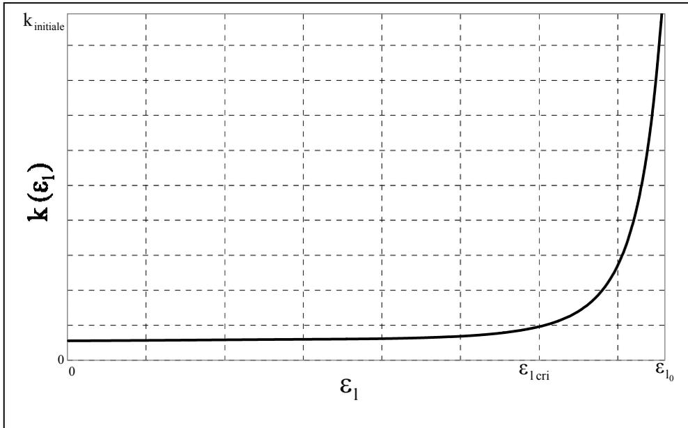
**Figure 4.5** Variation de la perméabilité ( $k$ ) en fonction de la fraction volumique du liquide ( $\varepsilon_1$ ).
