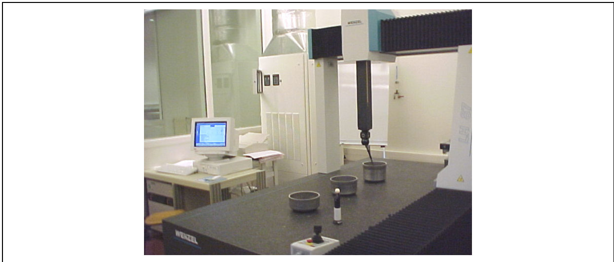
Figure III-3 : Installation pour les mesures du carter à ses trois phases de fabrication.
