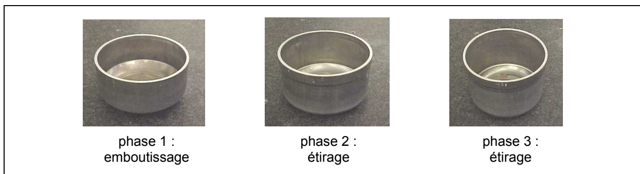
Figure III-1 : Carter de frein de camion aux différentes phases de sa réalisation.
