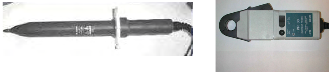
Figure II. 35 : A gauche, la sonde haute tension possédant un facteur d'atténuation de 1/1000. A droite, la pince ampèremétrique de sensibilité 100 mV/A.
