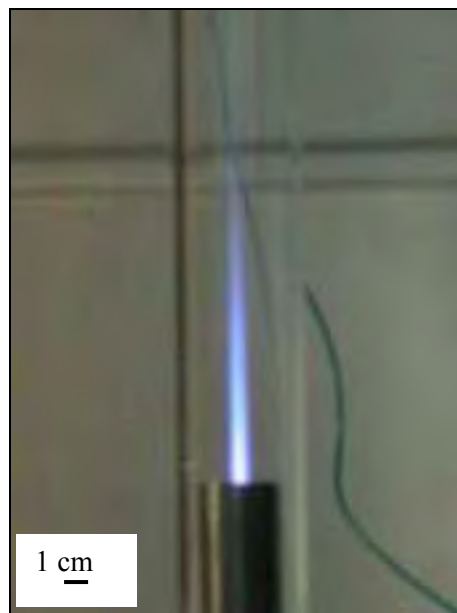
Figure III. 36 : Photographie du plasma en régime laminaire. Conditions opératoires : source électrotechnique avec une tension de sortie de 2500 V, une résistance de ballast égale à 9400 \Omega et la tuyère de cylindrique de longueur L = 100 mm.
