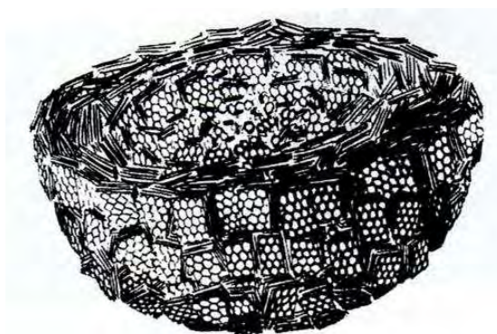
Figure I. 1 : Modèle représentant la structure en coupe d'une particule de noir de carbone composée de microcristallites [2].
