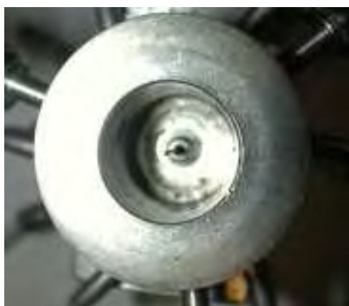
Figure IV. 47 : Vue de dessus de la tête d'injection de la torche plasma avec au centre l'électrode centrale. Au bout de l'électrode, on peut apercevoir la tige carbonée.
