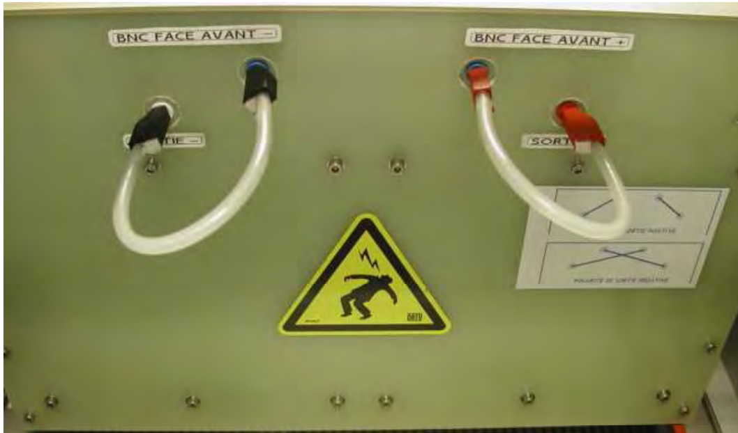
Figure II. 20 : Photographie de la face arrière de la source hacheur-dévolteur correspondant au brassage de la polarité de la tension. La photographie présente le montage pour une polarité de sortie positive.
