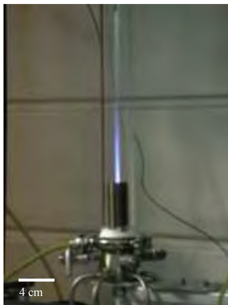
Figure III. 55 : Photographie du plasma lors de l'étape de préchauffage. Conditions opératoires : source électrotechnique avec une tension de sortie de 2500 V, une résistance de ballast de 9400 \Omega , un débit d'arcal 21 d'environ 140 NI/h et la tuyère cylindrique de longueur L = 100 mm.
