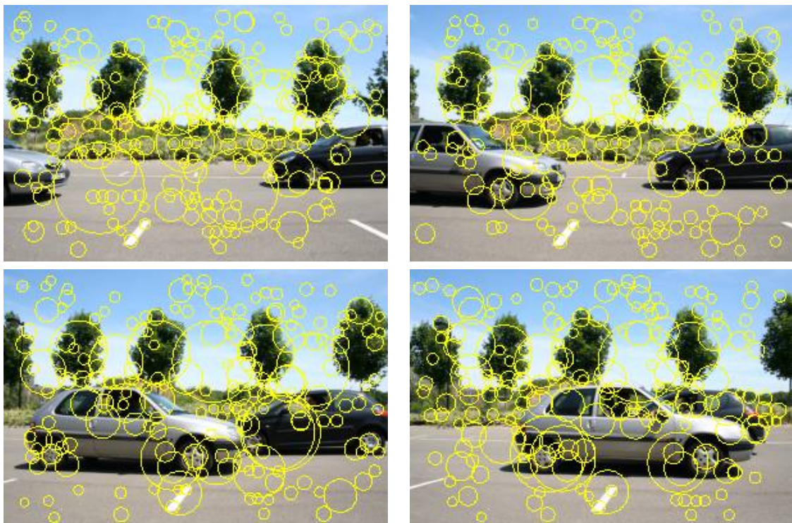
FIGURE 2.3 – Points obtenus via les Différences de Gaussiennes (DoG) pour 4 images de la séquence. Chaque cercle indique le centre du point d'intérêt et son échelle.
