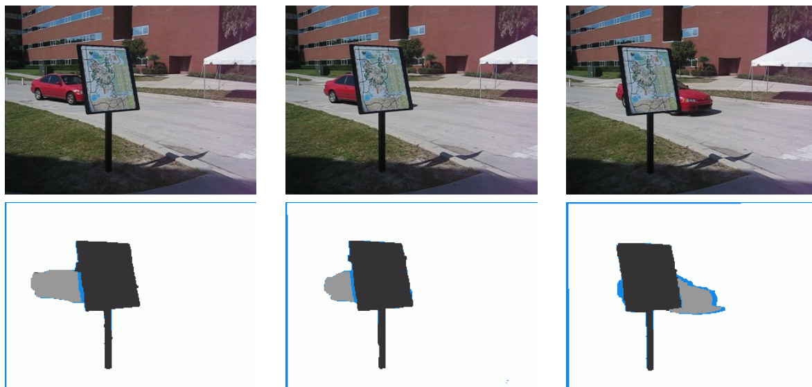
FIGURE 4.1 – Séquence vidéo et une segmentation en couches visibles + occultations (en bleu) extraites de [146] : les occultations représentent ici à la fois le bruit et l'absence de photoconsistance d'une image à la suivante.
