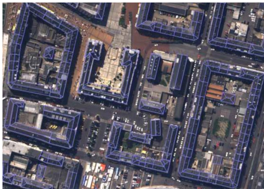
FIGURE 8.3 – Extraction automatique de la structure des bâtiments [49].
