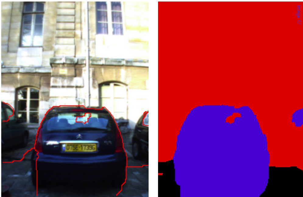
FIGURE 9.11 – Résultat de la segmentation en deux couches : à gauche, bordures des couches, à droite, chaque couche représentée par une couleur propre (en noir les occultations).
