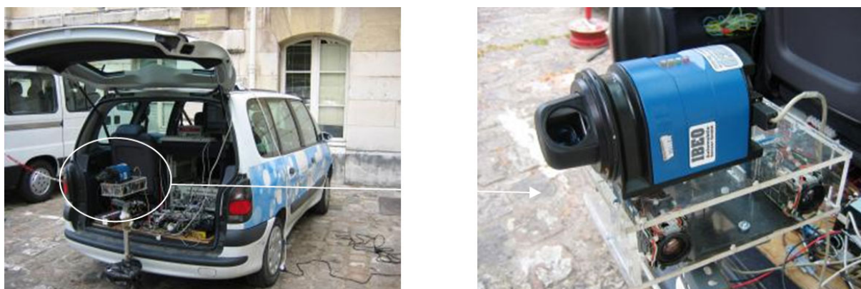
FIGURE 4 – Système d'acquisition « laser + caméras » de l'ENSMP, embarqué sur une voiture.
