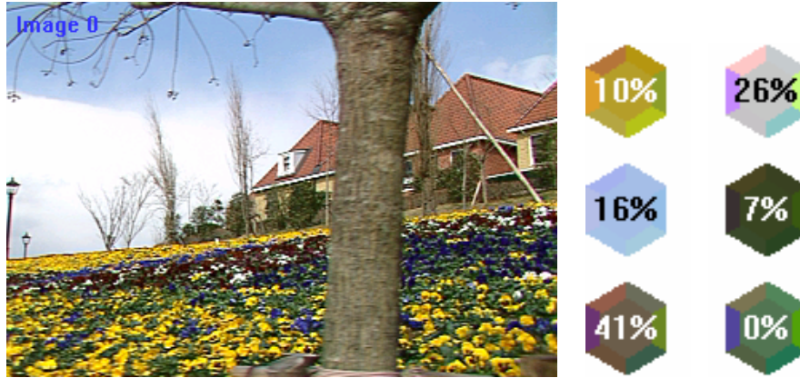
FIGURE 3.7 – Exemple d’une mixture de gaussiennes (à gauche de l’image) : ici, la distribution des couleurs de l’ensemble de l’image de gauche est modélisée par 6 gaussiennes. Chaque gaussienne est représentée par un hexagone qui indique sa proportion en pourcentage, la couleur moyenne (couleur de l’hexagone) et sa variance (sur les bords de l’hexagone) pour les trois couches RVB (ou LAB).
