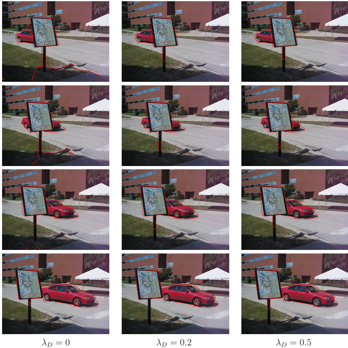
FIGURE 7.3 – Influence du paramètre \lambda_D sur les résultats sur la séquence Carmap (contours). Les lignes correspondent respectivement aux images 5, 13, 22 et 32.
