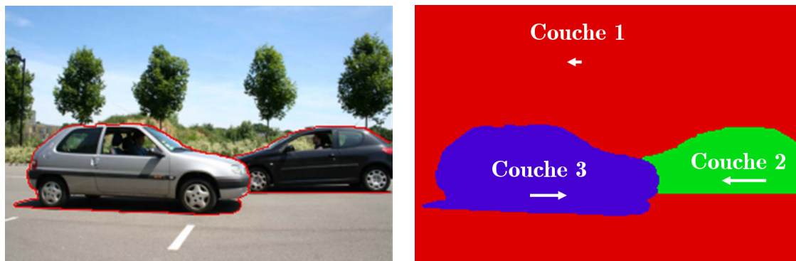
FIGURE 1.2 – Exemple de décomposition en couches : à gauche, l'image originale extraite d'une séquence vidéo, à droite sa décomposition en couches. Il y a ici 3 couches : 1) l'arrière-plan, 2) la voiture noire et 3) la voiture grise. Chaque région a son propre mouvement paramétrique (projectif ici).
