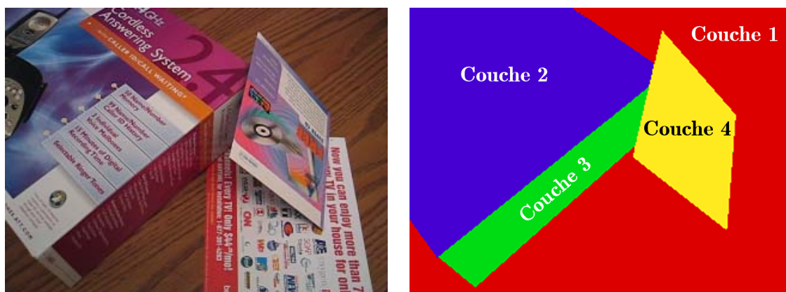
FIGURE 1.3 – Exemple de décomposition en couches : à gauche, l'image originale extraite d'une séquence vidéo, à droite sa décomposition en couches. Il y a ici 4 couches : 1) plan de la table (qui inclut le papier posé dessus), 2 et 3) plans de la boîte et 4) jaquette du cd-rom. Chaque couche représente un plan 3D.
