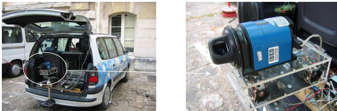
FIGURE 8.14 – Système d’acquisition de données télémétriques (et photographiques) géo-référencées : gros plan du bloc laser/caméras (fixé sur la boule de remorque de la voiture) à droite.
