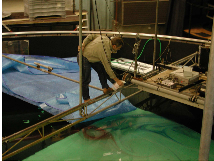
FIG. 4.15 – (a) Photo du cylindre. (b) Dissipation du colorant. A droite de l'image on peut observer le chariot qui permet de tirer le cylindre.
