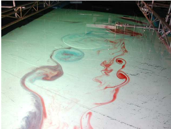
FIG. 4.16 – Couche de cisaillement (a) et allée tourbillonnaire (b) derrière le cylindre pour l'expérience n° 5, Bu = 0.09 et Ro = 0.07 .
