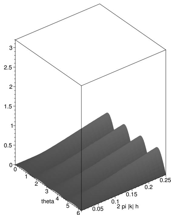
(c)  $c_{\Delta x,3}$  et  $c_{\Delta x,4}$ FIG. 9.12 – Vitesses de phase numériques en fonction de  $\theta$  et  $|k|h$ .  $V_P = 3$ ,  $V_S = 2$ ,  $\rho = 1$
