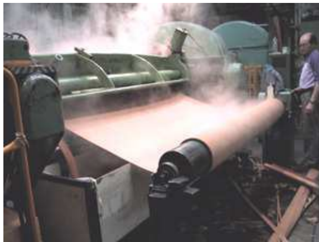
Figure 1 : Enroulage du placage en sortie de déroulage
