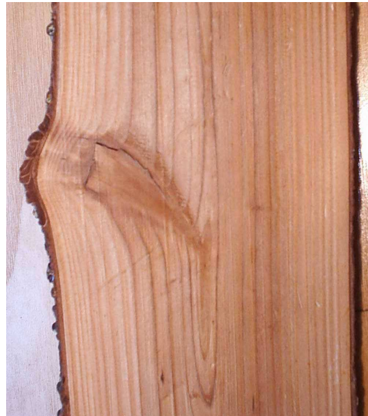
Figure 3 : Origine d'un nœud sur une coupe radiale d'un bois de cerisier
