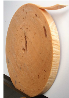
Figure 65 : Arrachements sur le billon de hêtre suite à la fabrication d'un placage rugueux
