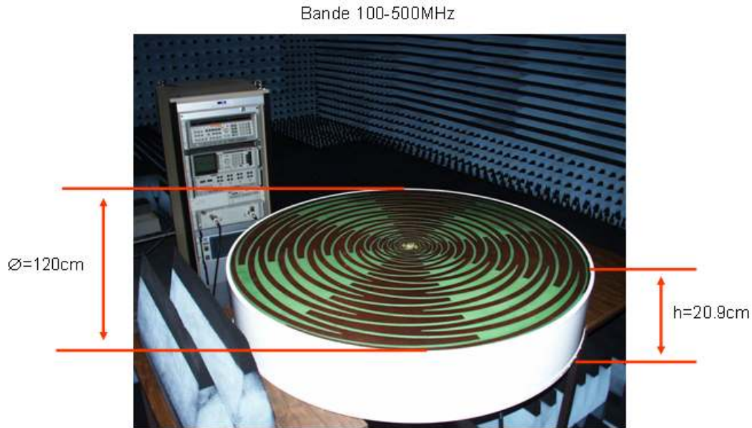
Figure 1.1 Antenne sinusoïdale bipolarisation placée au dessus d'une cavité absorbante
