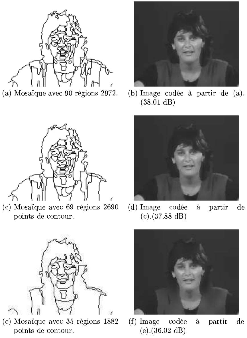
Figure 8.17: Simplification de texture utilisant les polynômes orthogonaux d'ordre 4.
