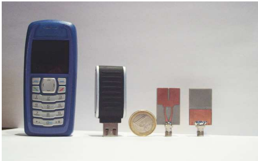
FIG. 3.48: Comparaison de la taille de l'antenne MSMR avec des terminaux mobiles.
