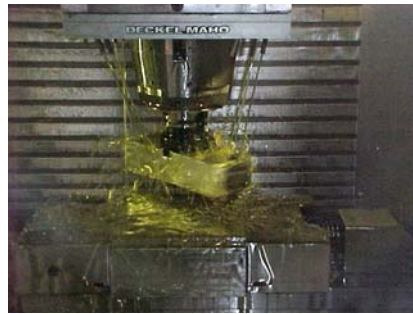
Fig. III-12 : usinage des éprouvettes.
