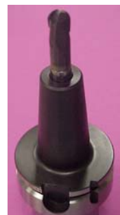
Fig. III-20 : fraise utilisée lors des essais
