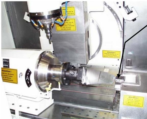
Fig. III-4 : montage d'usinage de l'aube HP1
