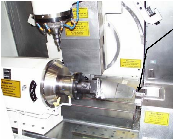
Fig. III-4 : montage d'usinage de l'aube HP1
