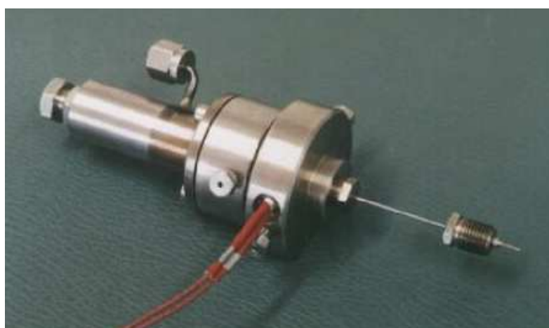
Figure V-2 Photo d'un ROLSI™ pneumatique
