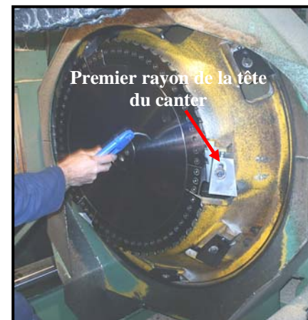
Figure.II.2.21: Positionnement des outils testés sur la tête du Canter
