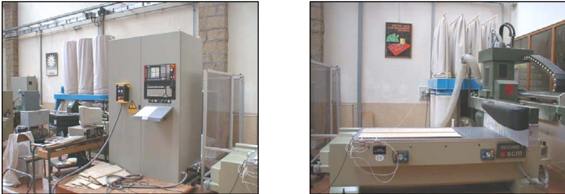
Figure.II.2.23 : Défonceuse 3 axes à commande numérique
