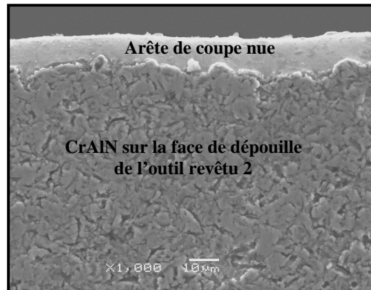
Figure.IV.3.18 : Arête de coupe de l'outil revêtu 2 après 3000 m de déroulage
