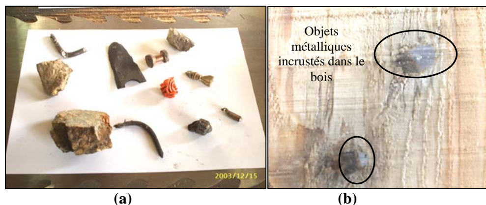
Figure.I.1.3 : (a) Objets trouvés dans le bois, (b) Objets métalliques incrustés dans le bois en scierie
