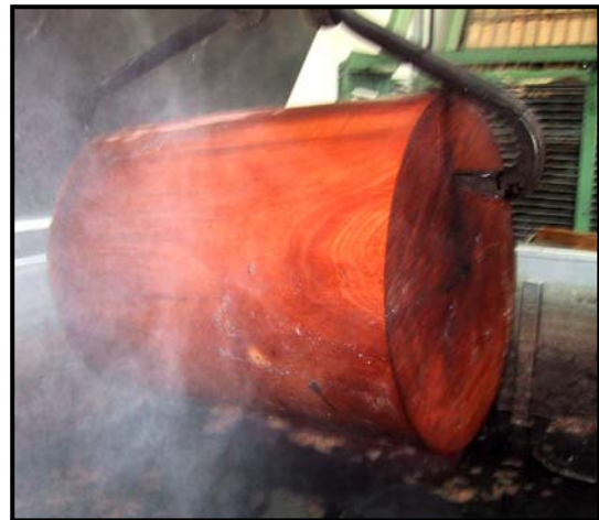
Figure.II.2.13 : Étuvage des billons de hêtre
