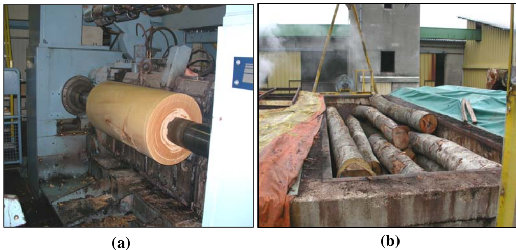
Figure.II.2.17 : (a) Dérouleuse 'RAUTE WOOD', (b) Cuve d'étuvage des grumes
