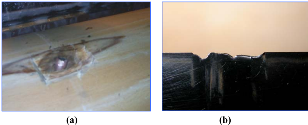
Figure.III.53 : (a) Balle incrustée dans le bois, (b) Cassure de l'arête de coupe
