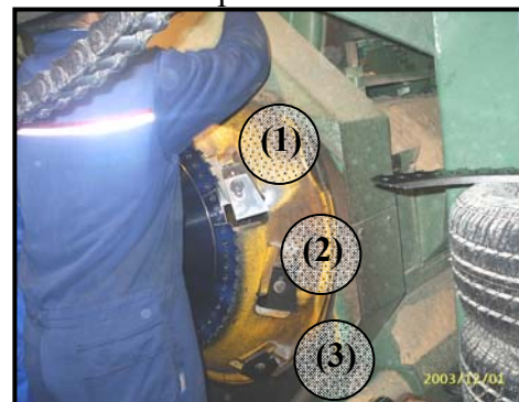
Figure.III.42 : Tête Canter avec ses différents rayons : 1, 2 et 3
