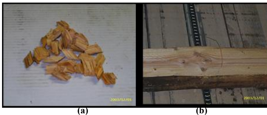
Figure.III.43 : (a) Plaquettes en bois produites avec les outils modifiés, (b) Surface d'une pièce équarrie
