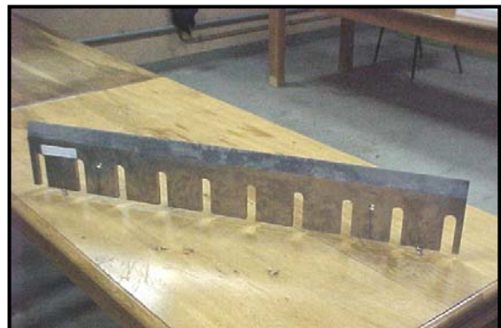
Figure.III.36 : Couteau de dérouleuse 'Sem-automation S500'
