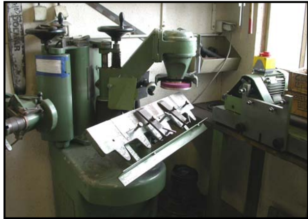
Figure.III.56 : Affûteuse industrielle utilisée
