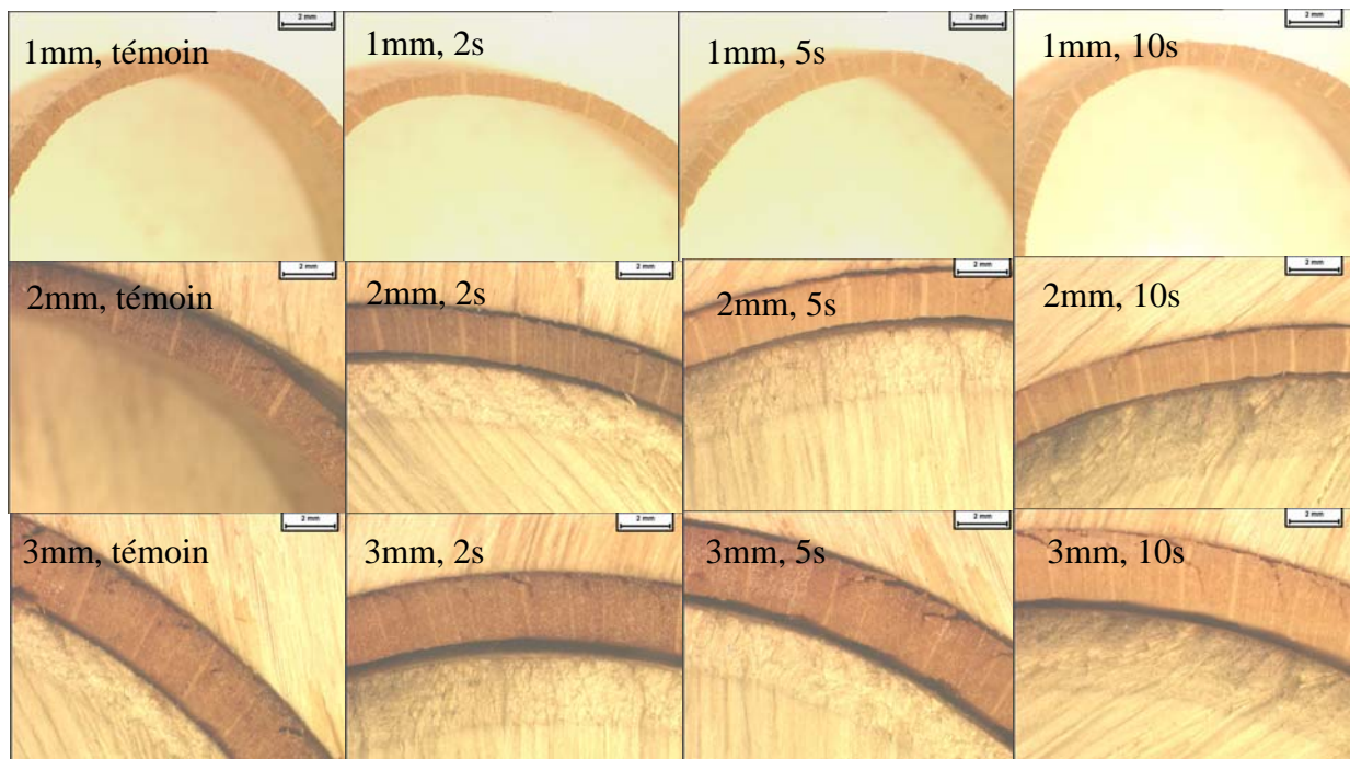
Figure.IV.3.7 : Placages produits en fonction de l'épaisseur du copeau et du type de traitement
