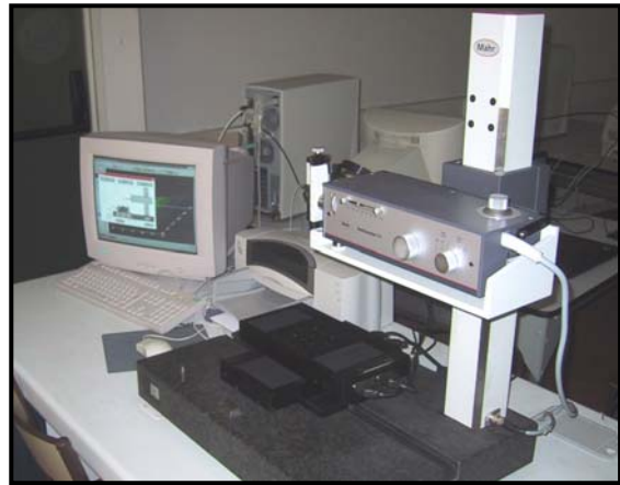
Figure.II.1.21. Perthomètre Concet (Mahr)
