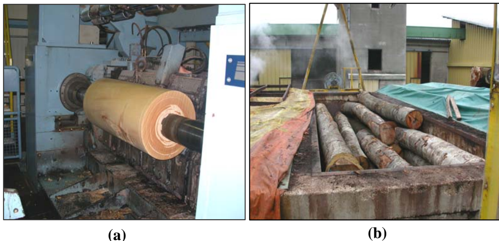
Figure.II.2.17 : (a) Dérouleuse 'RAUTE WOOD', (b) Cuve d'étuvage des grumes
