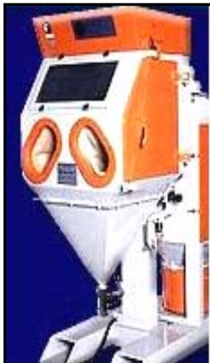
Figure.IV.3.1 : Sableuse VAPOR BLAST- ELVE HEC 221
