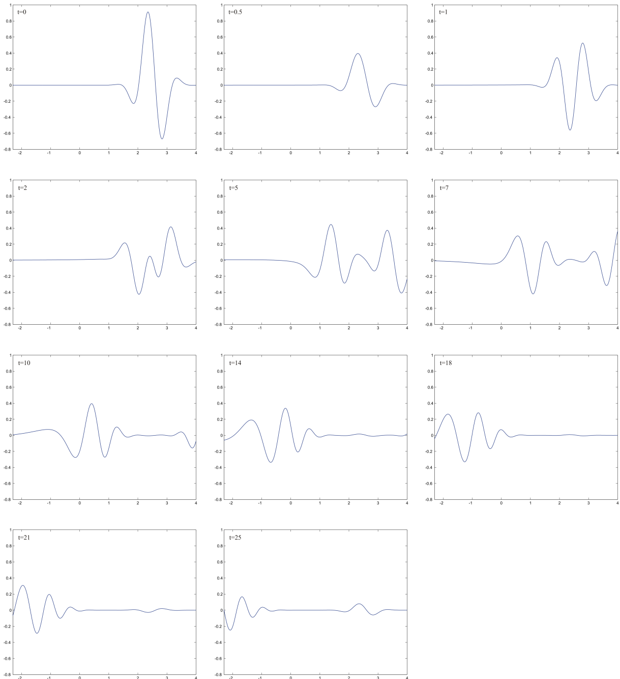
FIG. 45 – Des instantanés de l'onde incidente obtenus par la méthode de la transformée de LAPLACE.
