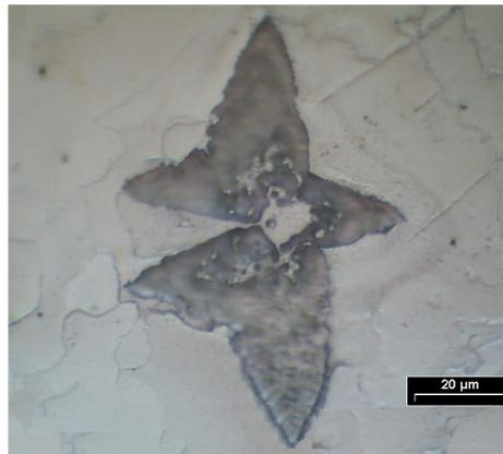
Figure 71 : Précipité propéritectique  $\text{Pb}_3\text{Ca}$  dans un lingot survieilli à 0,128%*pds*Ca.
