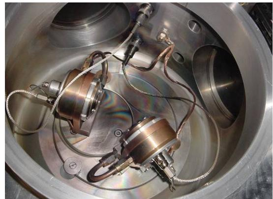
Figure 106 : amincisseur ionique à platine froide de l'IPCMS (Institut de Physique et Chimie des Matériaux de Strasbourg).
