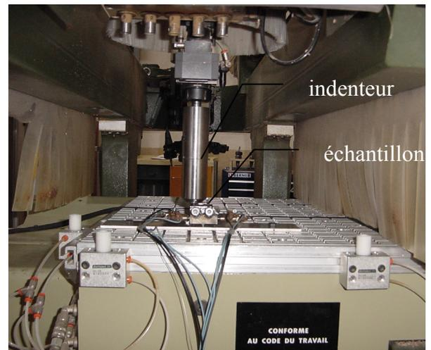
Figure 80 : SAMDRA présentant l'échantillon, l'indenteur, la machine 3 axes et le système de régulation thermique.
