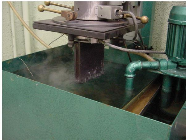
*Figure 57 : SAFT en position de trempe.*
