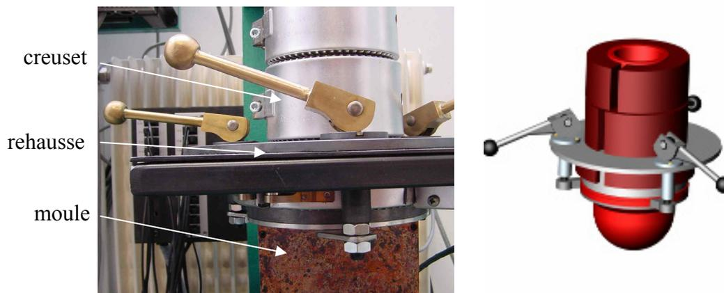
Figure 59 : système de fixation à cames.
