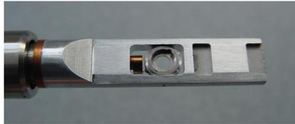
Figure 107 : porte lame cryogénique.
