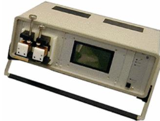
Figure 86 : appareil de mesure du PTE.
