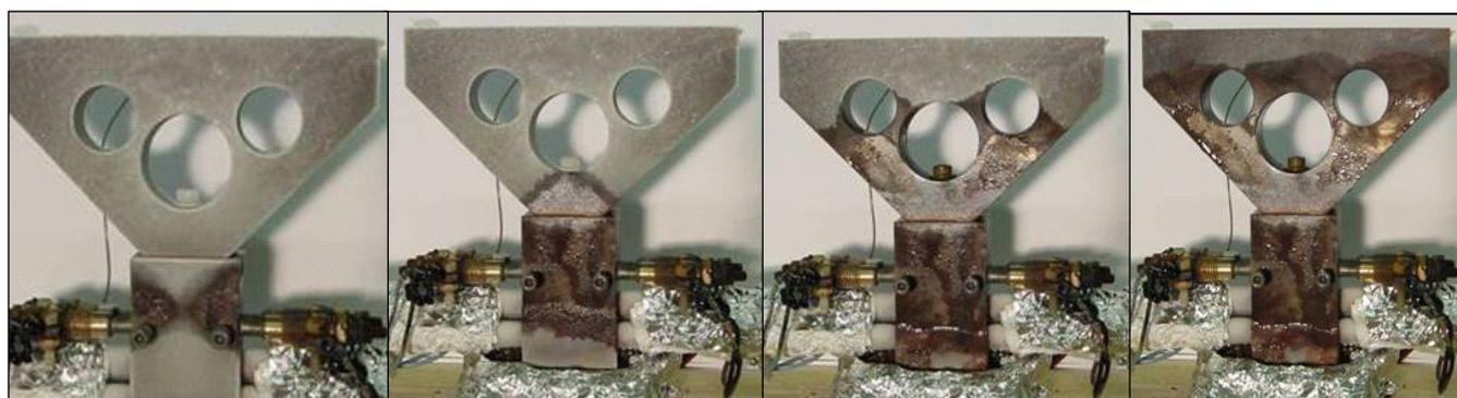
Figure 97 : visualisation du front de dégivrage du système de régulation.
