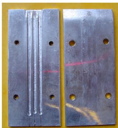
Figure 65 : moule pour échantillons de mesure de résistivité 4 points en ligne.
