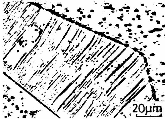
Figure 32 : Pb-0,04%pdsCa trempé à l'eau à 0°C et vieilli 20 heures à 200°C [TSUBAKINO 1990].
