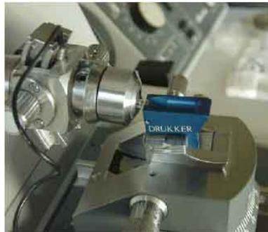
*Figure 100 : opération de coupe par ultramicrotomie.*
