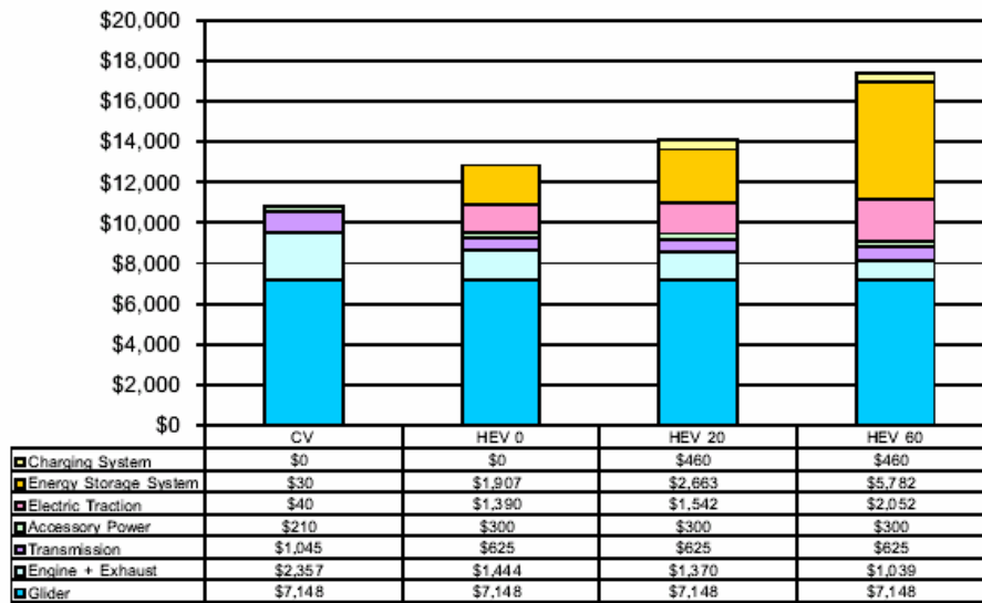
Figure 6.21. Coûts des composants d'un GMP en 2010.
