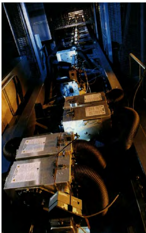
FIG. 1.11 – Photographie d'une tour de fibrage [FARRELL, 2002]
