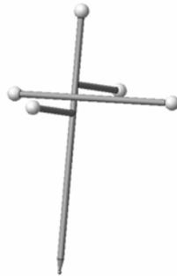
**Figure 31: Stylo permettant de localiser les coordonnées des repères osseux palpés du pouce**
